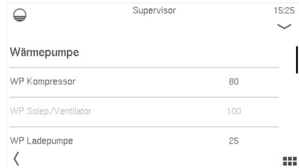
Test de fonctionnement de la pompe à chaleur avec une vitesse de rotation du compresseur prédéfinie
