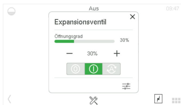
Degré d'ouverture manuel de la vanne d'expansion
