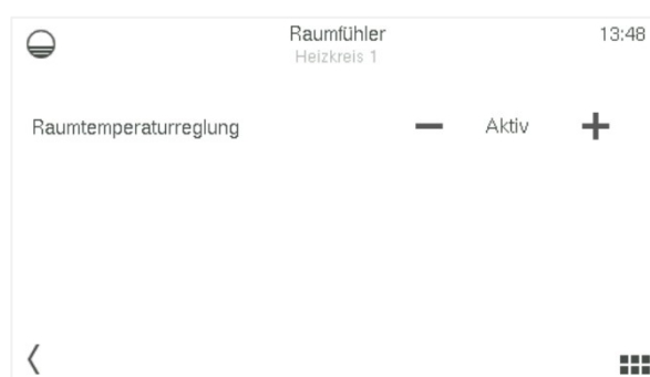
Activation de la régulation en fonction de la température ambiante
